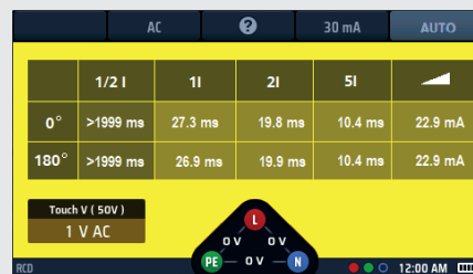
Afb.49: Voortgang resultaat AUTOMATISCHE aardlekschakelaartest
