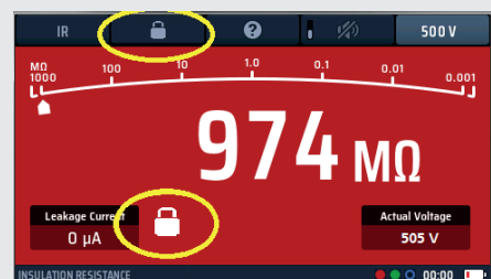
Afb.23: Vergrendeling van de isolatie weerstandstest
